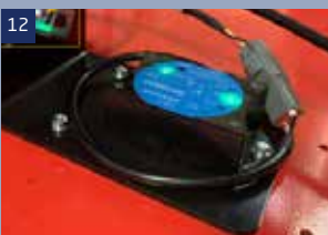
Neigungssensor: beim Heben und Fahren an einem Gefälle, prüft der Sensor automatisch den Neigungswinkel der Maschine, wenn die Neigung größer ist als der Nennwinkel, löst der Alarm für den Bediener aus
