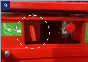
Manuelles Absenkenventil: Selbst bei niedrigem Batteriestatus oder Versagen der Steuerung lässt sich die Bühne mit diesem manuellen Absenkenhebel immer noch absenken
