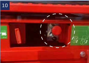
Manuelles Freigabe-Ventil. Wenn die Fahrfunktion der Plattform nicht reagiert, kann die Maschine nach betätigen des Ventils manuell verfahren werden
