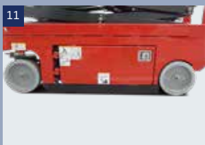
Ein automatischer Kippschutz greift ein, sobald bei einem Hub oberhalb von 2 m auf unebenem Grund Bewegungen stattfinden
