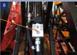
Explosionsgeschütztes Ventil zum Schutz vor Unfällen bei Ölaustritt
